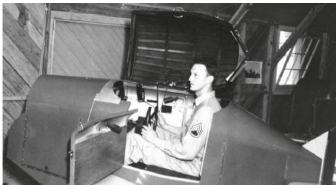
Rysunek 1. Symulator lotu — „link trainer“
